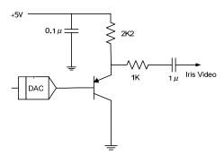
Fig. 25. Video output circuit.
