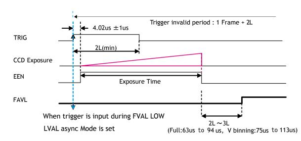
Fig. 30 Edge Pre-select LVAL a-sync Timing
