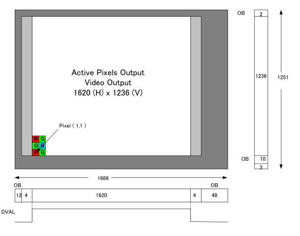
Fig. 15. CCD sensor layout
