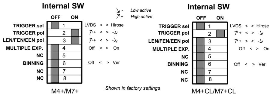
Fig. 26. Internal Switch
