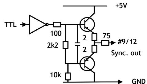
Fig. 7. Composite Sync. output
